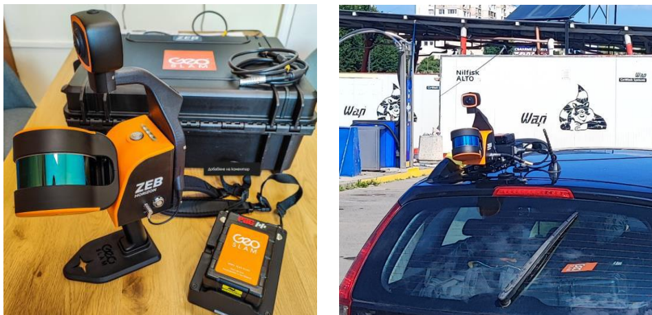
Фиг. 2. Мобилен лидарен сензор Zeb Horizon прикрепен към покрива на лек автомобил.
