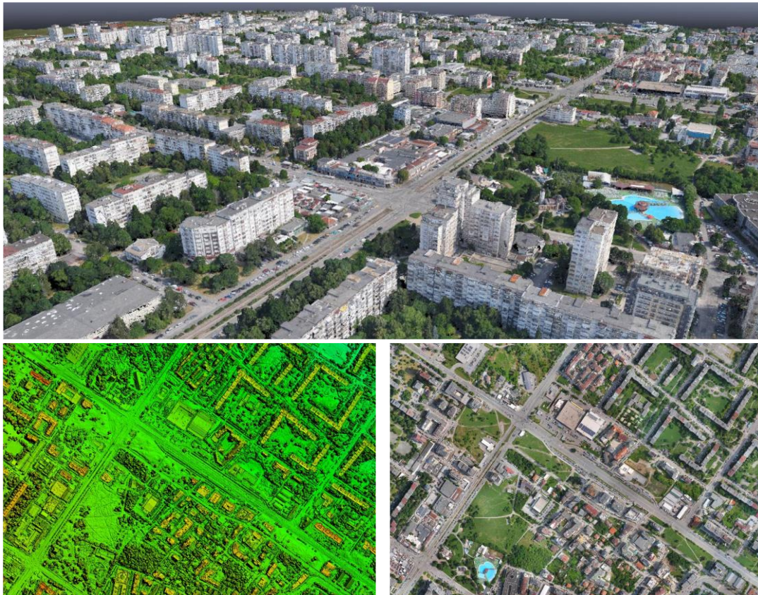
Фиг. 1. (горе) Подобен 3D облак от точки в изследваната територия, получен след фотограметрична обработка в Pix4D среда. (долу) Цифров модел на повърхността (DSM) с висока пространствена разделителна способност (5cm/pix); (Ортофото карта с висока пространствена разделителна способност (5cm/pix) /визуализирани в софтуерна среда – Global Mapper/
