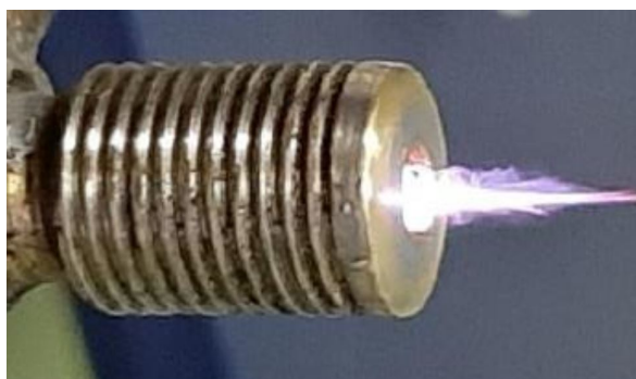
Фигура 22: Работа на предложения двигател при атмосферно налягане.
