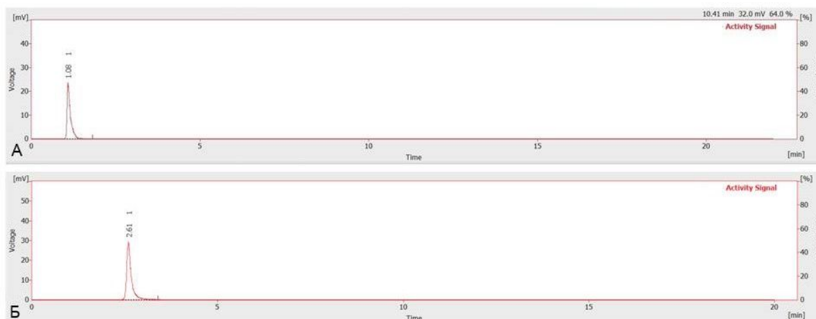
Фигура 25 – Радио-HPLC анализ при маркиране на R2: А – RAD – хроматограма на изходна [^{18}\text{F}]\text{FDG} ( t_r=1,08 мин.); Б – RAD – хроматограма на маркиран продукт Pr5 ( t_r=2,61 мин.)
