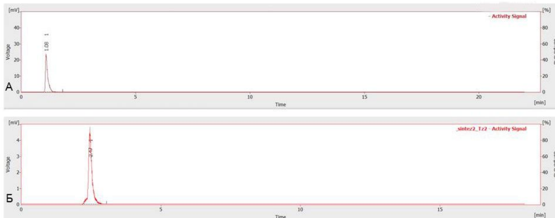
Фигура 15 – Радио-HPLC анализ при маркиране на Tz2: А – RAD хроматограма на изходна [^{18}\text{F}]\text{FDG} ( t_r=1,08 мин.); Б – RAD – хроматограма на маркиран продукт Pr2 ( t_r=2,47 мин.)
